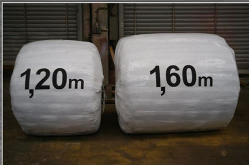
Einstellbare Ballenhöhe von 1,20 m bis 1,60 m. Dadurch Anpassung der Ballen an das Transportfahrzeug, optimale Nutzung des Ladevolumens und Reduzierung der Transportkosten. Ballendurchmesser fix bei 1,50 m.
