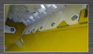
通过螺丝固定的齿犁,在其底部加装了三角形的支撑柱, 保证其不会因长时间受力而折断。
