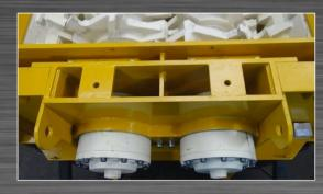
可选:在轴承前端,单独设计出的空间(上下开口),可防止缠绕物和磨损材料直接进入轴承内部,可明显增强轴承的使用寿命。 / Option: Additional free space in front of the tool shaft bearings
